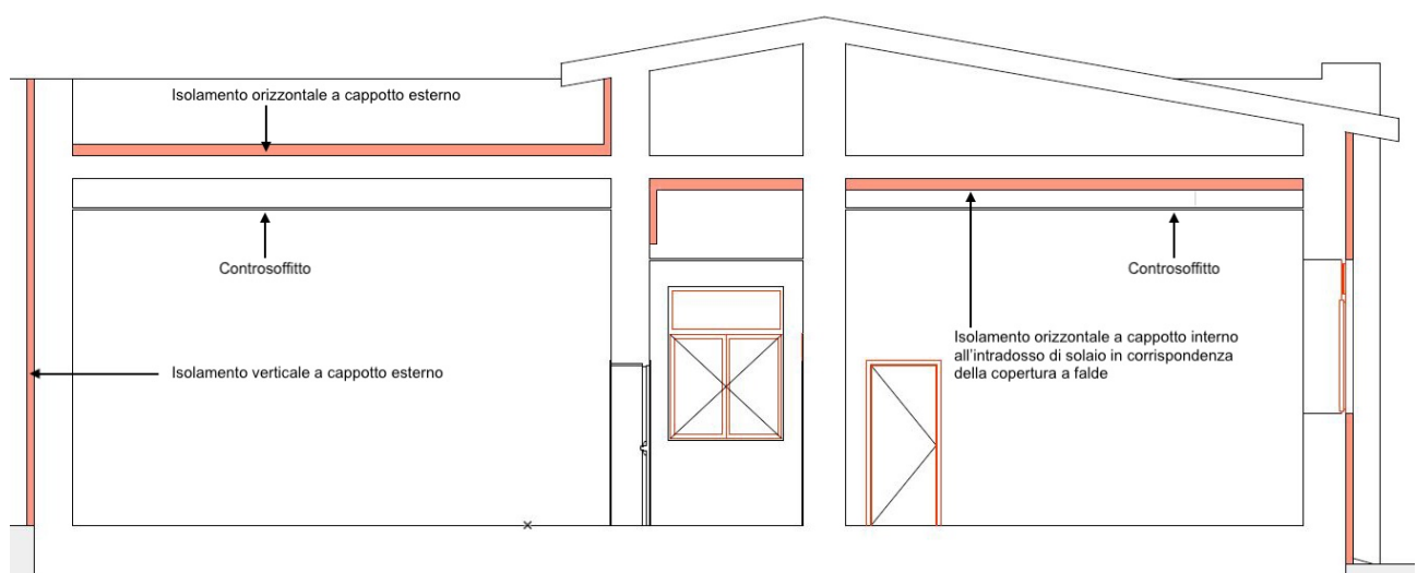
Figura 24 – Sezione tipo con indicazione del cappotto
